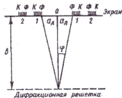
Рис. 1. Ход лучей в дифракционной решетке
